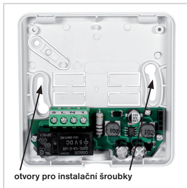
Rys.4 Umieść część z elektroniką na dolnej części i zabezpieczyć śrubą blokującą.
